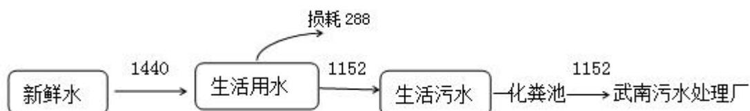
图 2-1 扩建后全厂水平衡图 (t/a)
