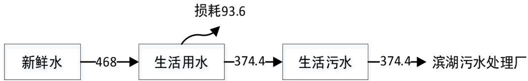
图 2-1 验收项目水平衡图 (t/a)
