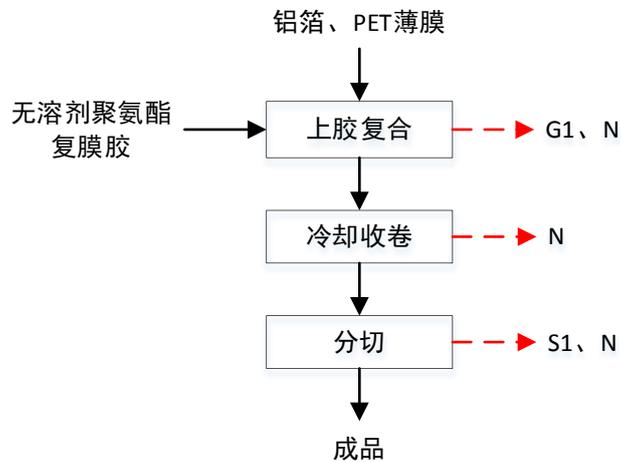
（注：Gn：废气污染物；Sn：固体废弃物；Nn：噪声）
