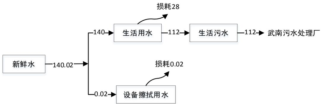
图 2-1 验收项目水平衡图 (t/a)
