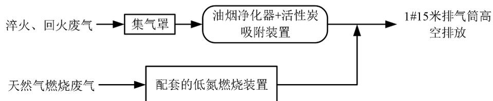
图4-2本项目废气处理工艺流程图
