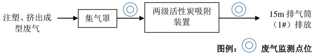
图 3-2 有组织废气处理流程图及监测点位
