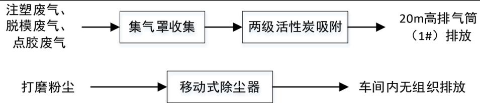
图 4-1 本项目废气处理工艺流程图
