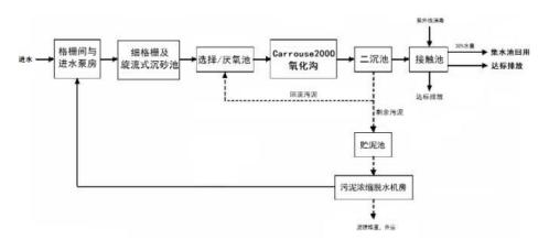
图 4-2 武进城区污水处理厂污水处理工艺流程图
