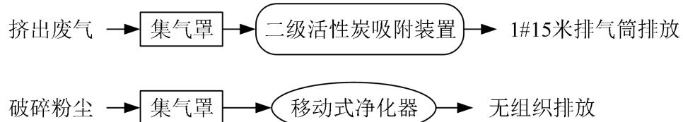
图4-1废气处理流程图
