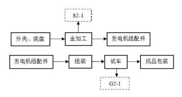
图 1-2 发电机组组装工艺流程图
