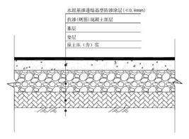
图 5-7 装置区地坪防渗结构示意图
