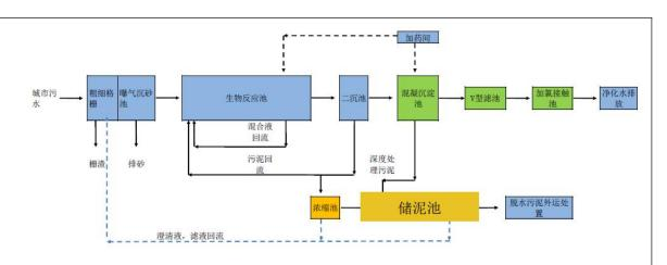
图 5-7 武南污水处理厂处理工艺流程
