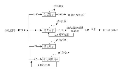
图 5-4 本项目水平衡图
