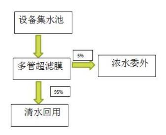
图 5-6 清洗废水处理工艺流程图
