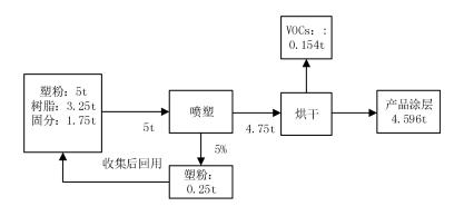
图 5-4 塑粉平衡图
